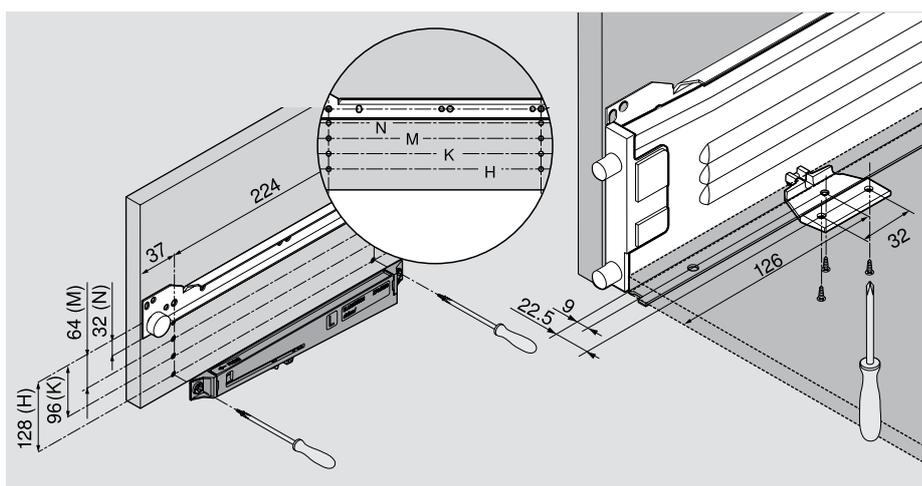
System 32: El montaje de la unidad de BLUMOTION se realiza en la marca 32 mm de taladrado.
