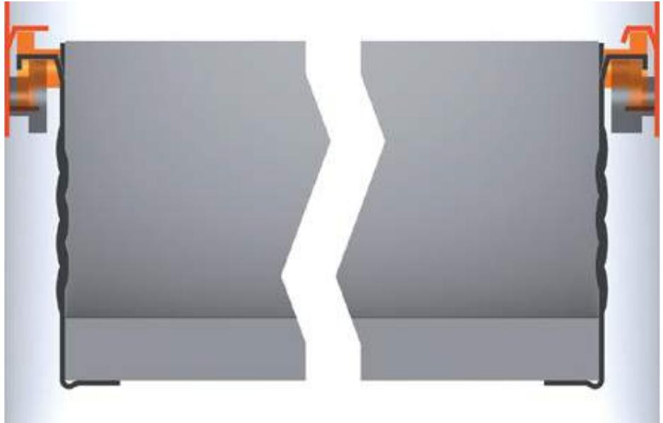
La compensación de las tolerancias tiene lugar en el lado izquierdo del cuerpo. El cajón o módulo extraíble se estabiliza lateralmente en la guía derecha.
