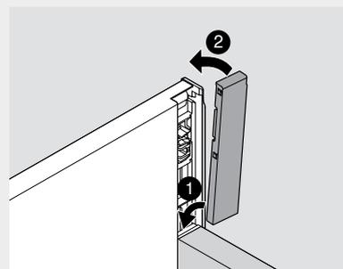
La tapa de soporte de trasera se puede usar con soportes de madera y de acero y se monta con clips sin herramientas en el perfil correspondiente.
