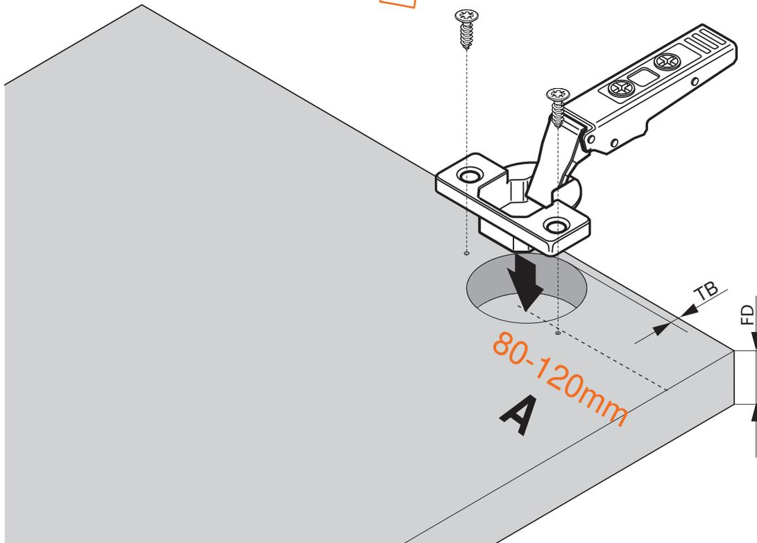
TB: 铰杯边距 FA: 面板重叠部分 FD: 面板厚度 A: 从铰杯孔中心到面板边缘的距离
