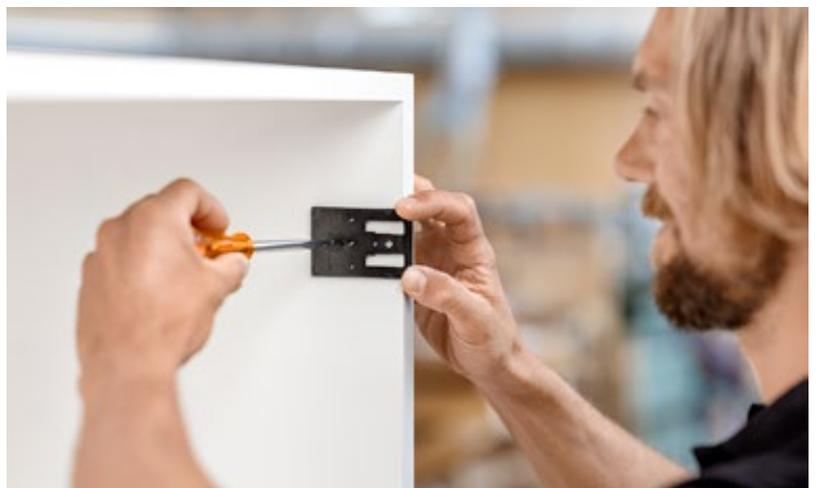
Nuestras ayudas de montaje le ayudarán, por ejemplo, a posicionar y asegurar el mecanismo de elevación AVENTOS en el cuerpo de mueble. Mediante una alineación óptima, se garantiza que los herrajes funcionen perfectamente. De este modo, los movimientos de apertura y cierre serán mucho más cómodos.
