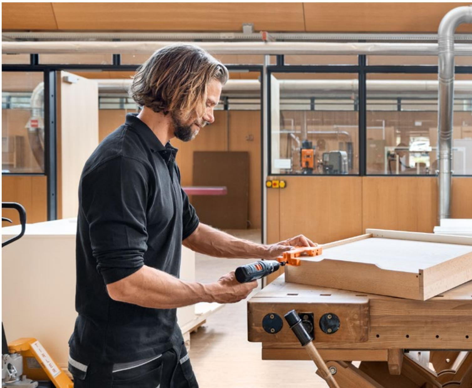
Mediante el taladrado previo, es posible colocar los herrajes con una precisión aún mayor. Esto es importante, en especial, en el caso de la madera y, de esta forma, también para la fijación de las guías en el cajón. Con nuestras plantillas de taladrar, es posible determinar la posición del taladrado exacta de manera particularmente eficiente. Y aún más sencillo resulta con MINIPRESS top. Si los cajones se colocan de forma correcta en las guías, garantizará un deslizamiento ultraligero.
