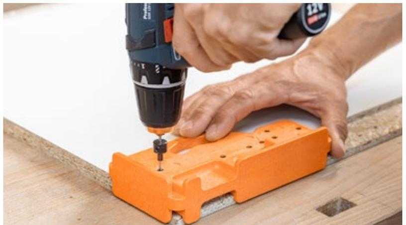
La disposición de los taladrados es un paso de trabajo que requiere la mayor precisión. Con nuestras plantillas de taladrar, marcar y taladrar previamente las posiciones de fijación de las guías de cuerpo de mueble es una tarea muy sencilla. Prepare los componentes para el montaje de manera ideal en un instante.
